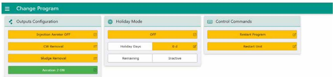
Figura 6: Individualización del programa SBR de un tanque a través de páginas web internas
