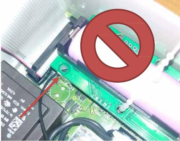
Figura 10: Colocación del módulo GSM
